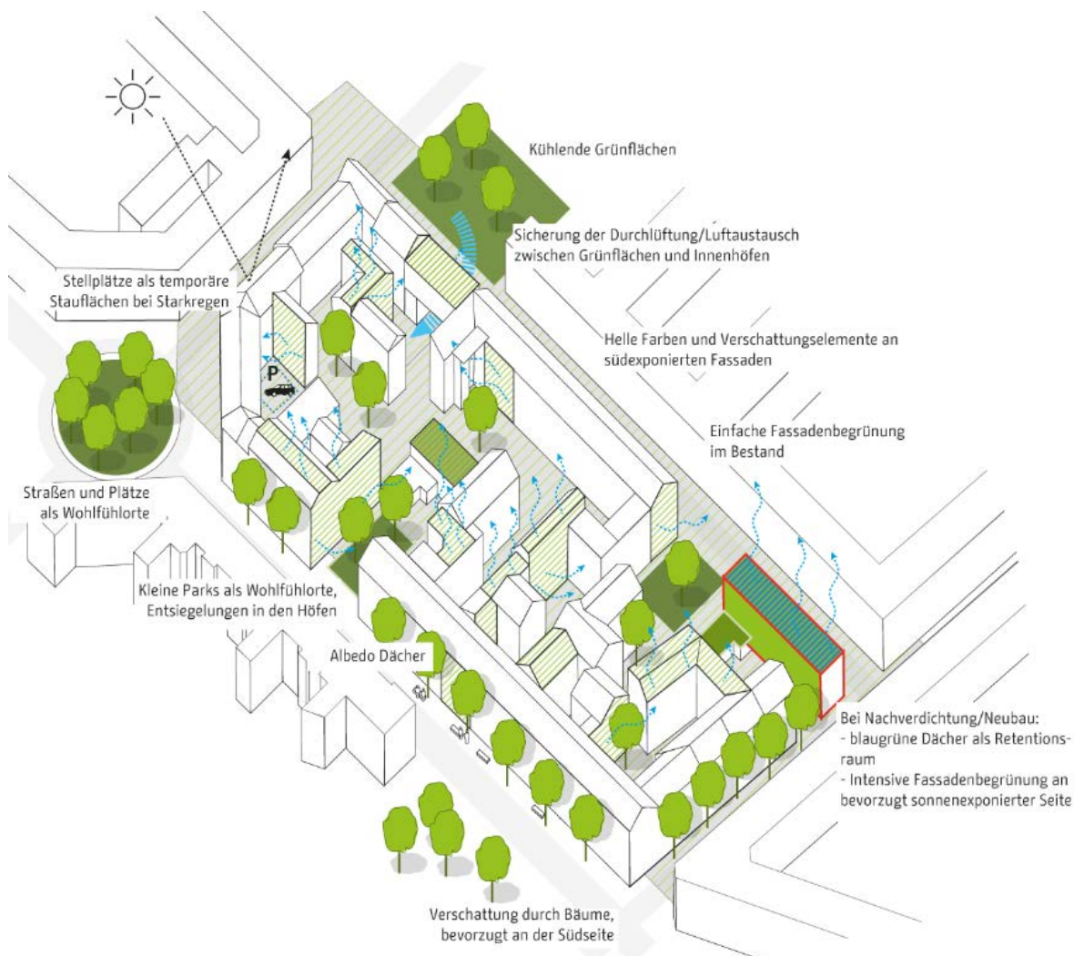
Abbildung 52: Mögliche Anpassungsmaßnahmen im Stadtstrukturtyp Verdichtete Blockrandbebauung, StEP Klima KONKRET; Quelle: STEP KLIMA KONKRET, SENSTADTUM/BGMR 2016.
